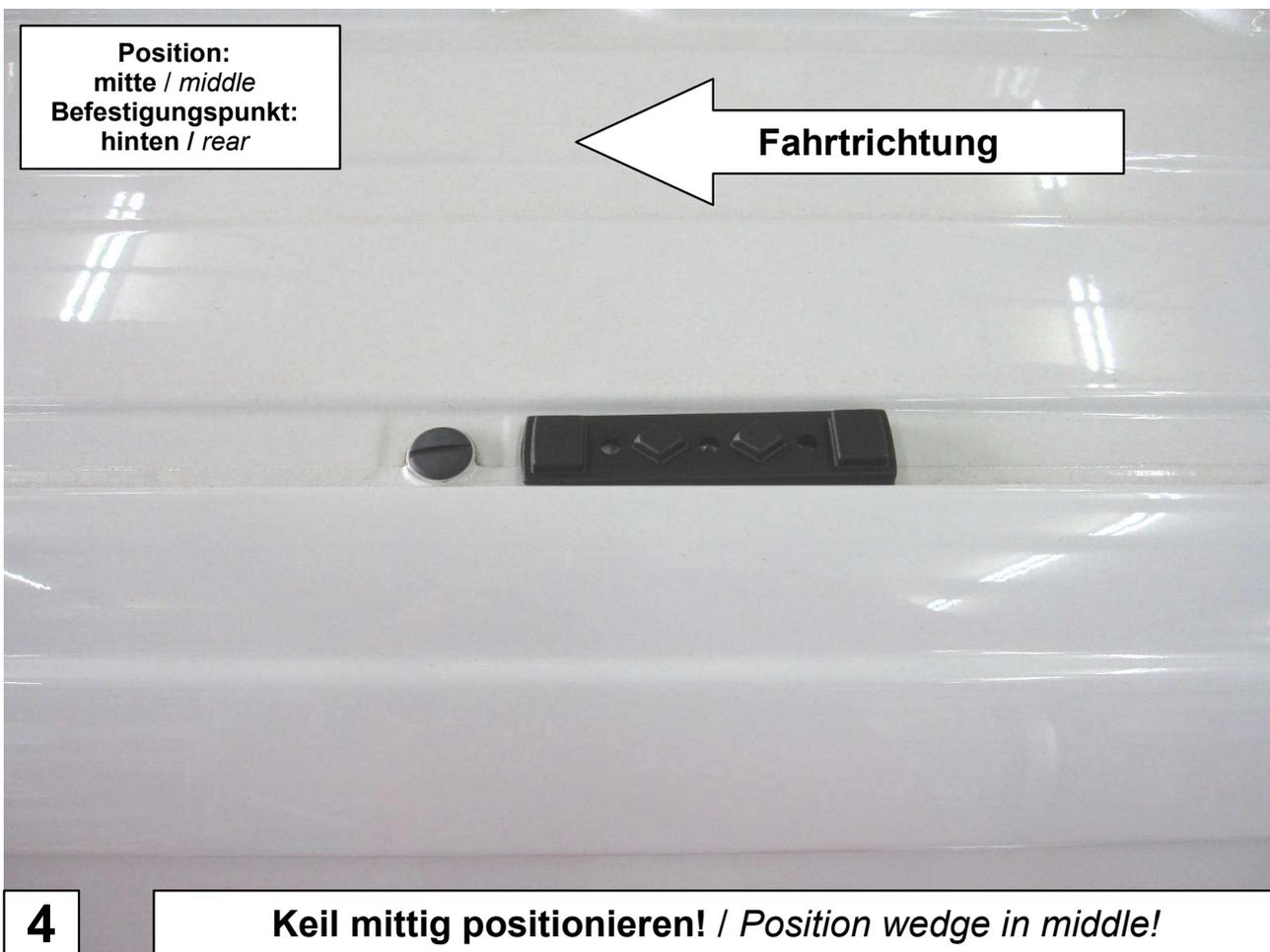
**Keil mittig positionieren! / Position wedge in middle!**
