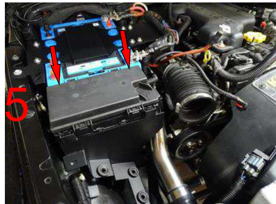
Sicherungskasten jetzt auf den Laschen einklipsen lassen
