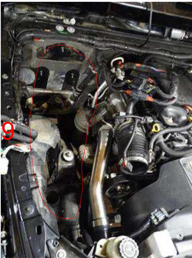
Original Batteriekasten komplett entfernen, wird nicht mehr benötigt !
