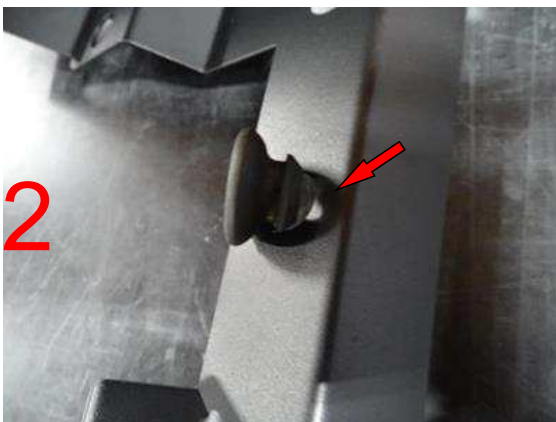
Sicherungskasten an Laschen leicht aufsetzen, noch nicht einklipsen lassen!
