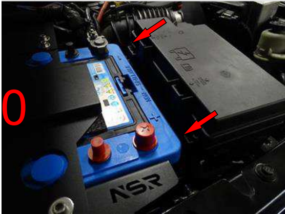
Sicherungskasten an Laschen leicht aufsetzen, noch nicht einklipsen lassen!
