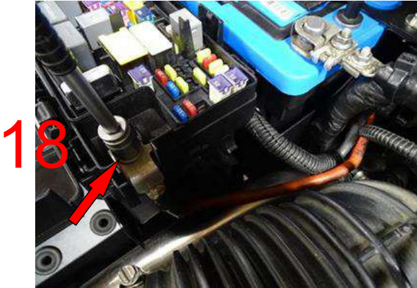
Plus + Sicherungskasten verschrauben
