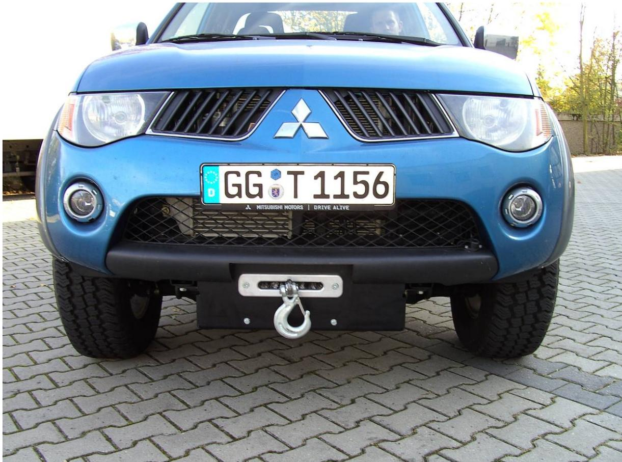
**Hier sehen sie den fertig montierten Seilwindenanbausatz.
