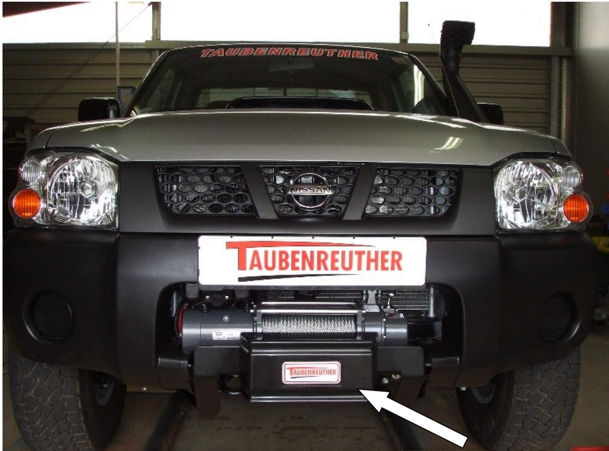
**Hier sehen sie den fertig montierten Seilwindenanbausatz.
