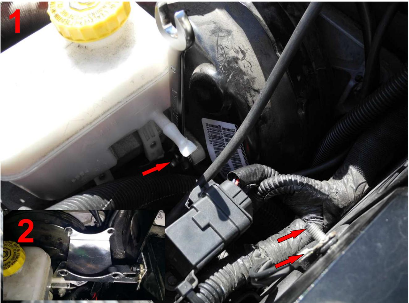
3. Setzen Sie die Gummipuffer aus dem Originalhalter in den NSR Halter ein und verschrauben Sie nun den Kompressor mit dem NSR Halter.
