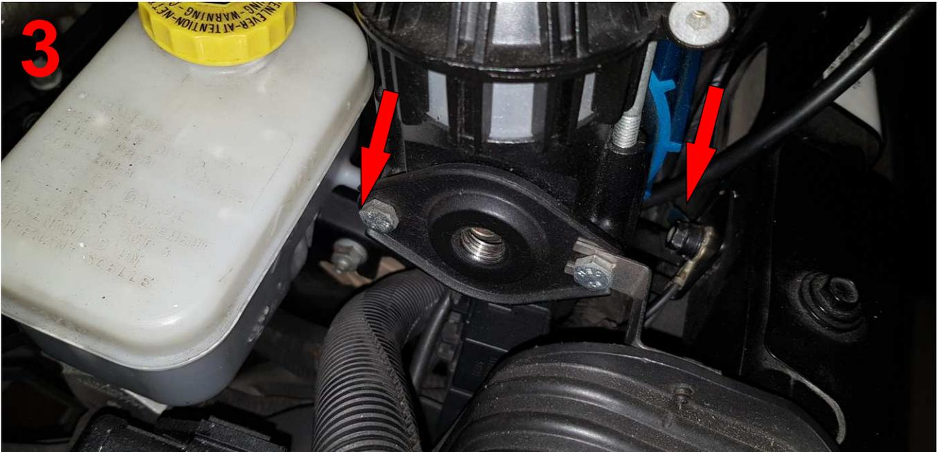
5. Setzen Sie das Massekabel sowie die Mutter wieder auf den Bolzen und verschrauben diese. Schrauben Sie die gelöste Schraube am Bremskraftverstärker wieder fest.
