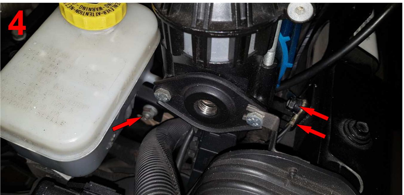
6. Verschrauben Sie den Anti Vibrations Winkel.
