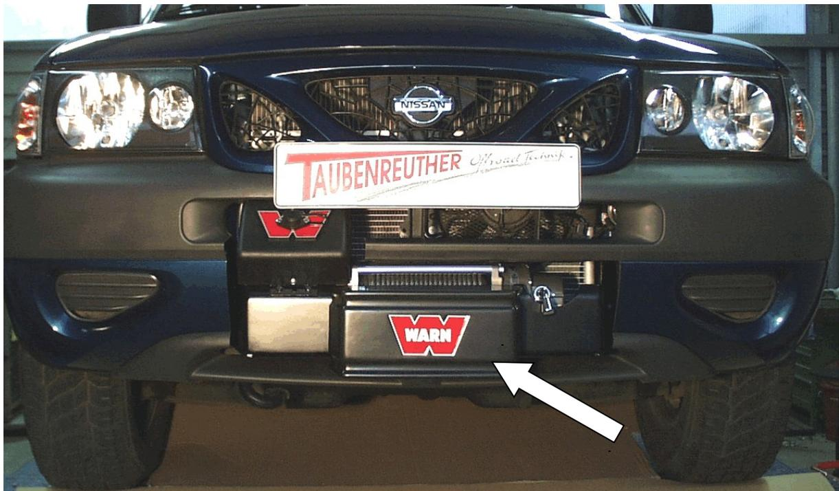
Hier sehen sie den fertig montierten Seilwindenanbausatz.
