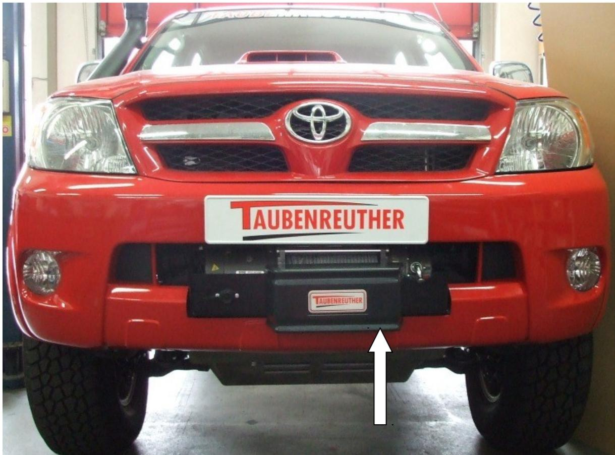
Hier sehen sie den fertig montierten Seilwindenanbausatz.
