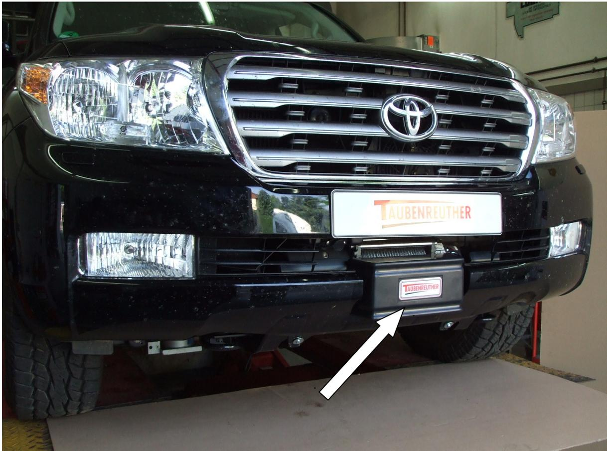
Hier sehen sie den fertig montierten Seilwindenanbausatz.
