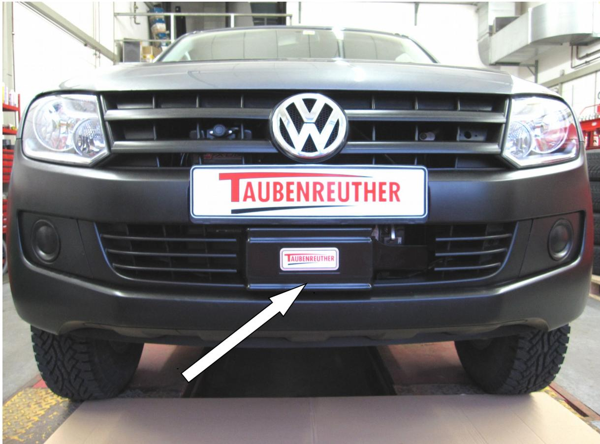
**Hier sehen sie den fertig montierten Seilwindenanbausatz.
