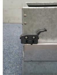
66. **Montieren Sie den festen Boden im Stapel-System.** Verwenden Sie einen 4mm Sechskant-Inbusschlüssel zum Festziehen des Bodens. Verwenden Sie die Original Senkkopfschrauben.
