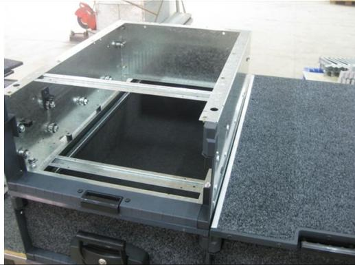
65. **Montieren Sie die Roll-Schubladen im Stapel-System.** Rollen Sie die Schubladen hinein. Schrauben Sie die Schubladen-Stopper mit den Original 6mm Schrauben fest. Verwenden Sie die 6mm Flach-Distanzscheiben dabei. Wie Sie sehen können, zeigen die Arme der Schubladenstopper nach **hinten**. Außerdem zeigen die Nylock-Muttern der Schubladenstopper nach **außen**, weg vom Schubladengehäuse und bündig zu den 6mm Schrauben. Siehe Arbeitsschritt 53.
