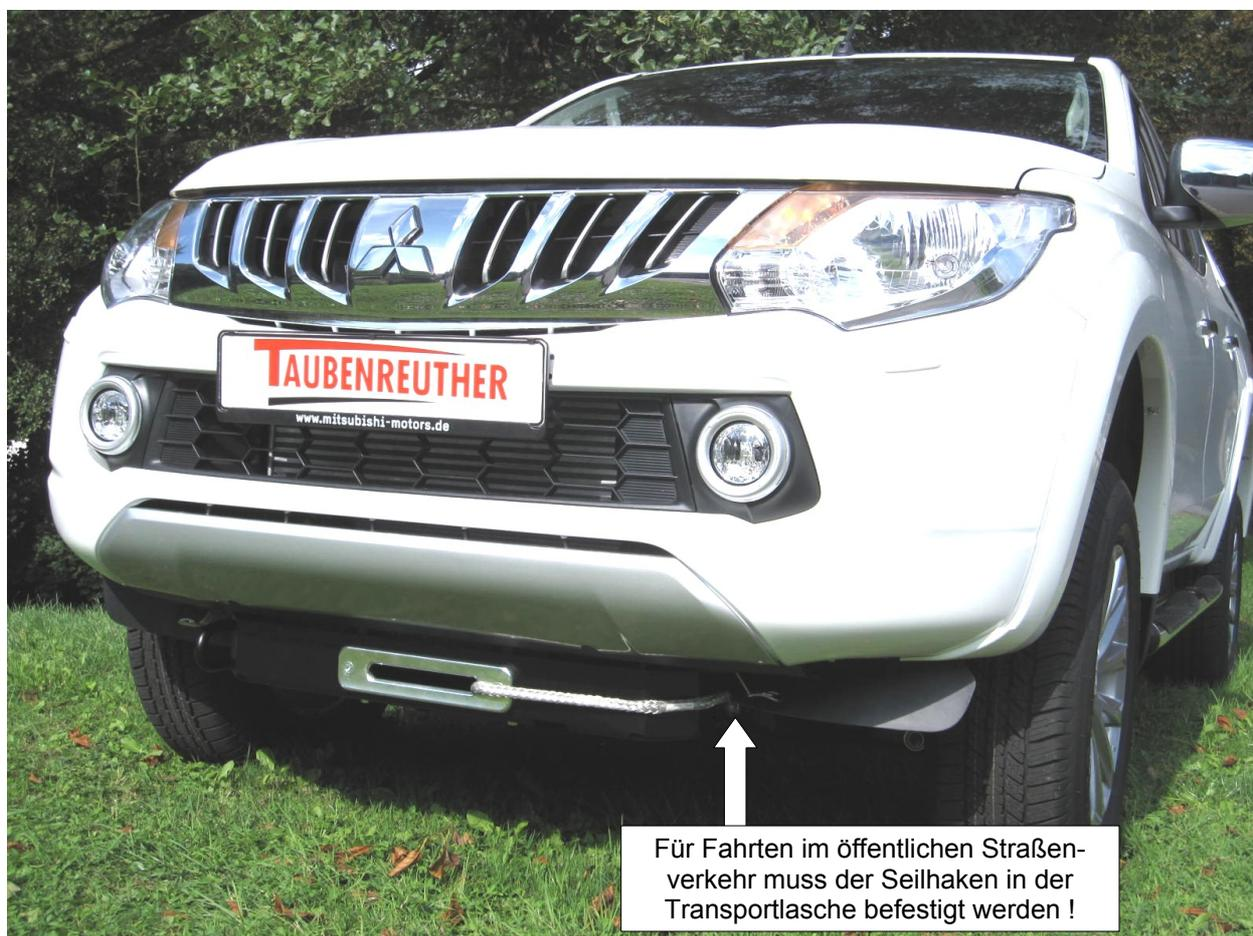
**Hier sehen sie den fertig montierten Seilwindenanbausatz.
