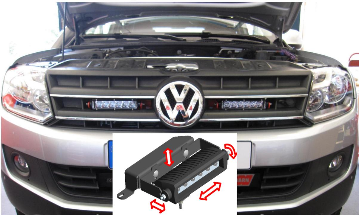
Scheinwerfer anschließen und ausrichten!
