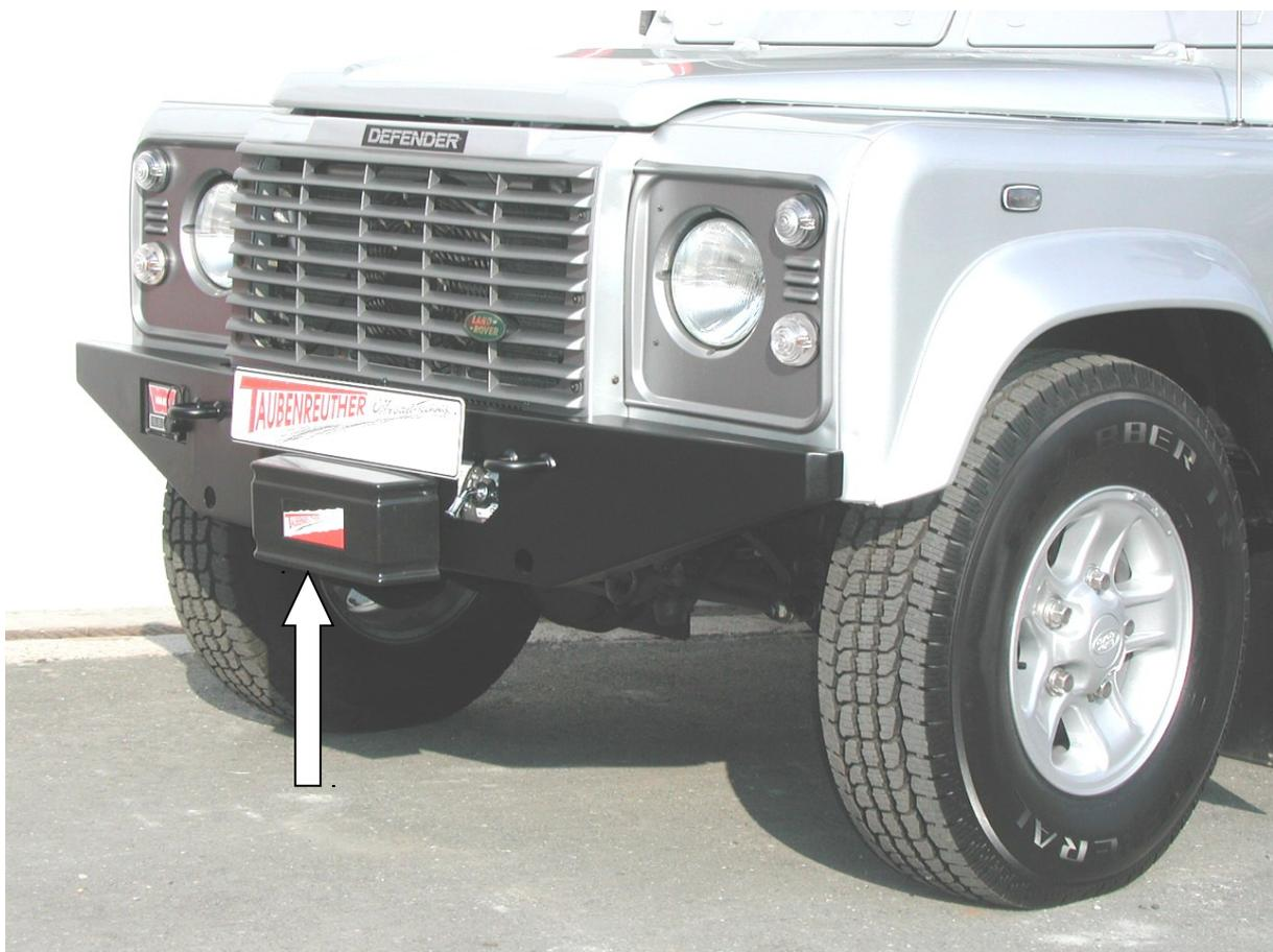
**Hier sehen sie den fertig montierten Seilwindenanbausatz.**
