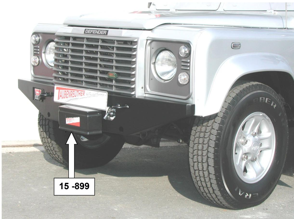
**Hier sehen sie den fertig montierten Seilwindenanbausatz.
