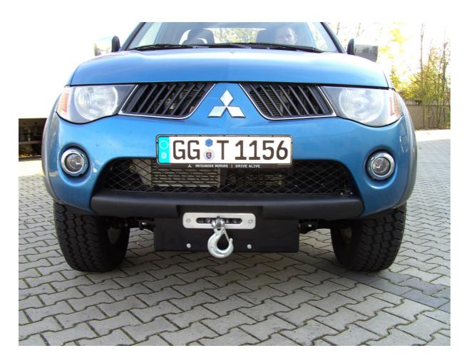
Hier sehen sie den fertig montierten Seilwindenanbausatz. Bevor sie mit der Montage beginnen, lesen sie bitte diese Anleitung und das Benutzerhandbuch der Seilwinde gut durch.
