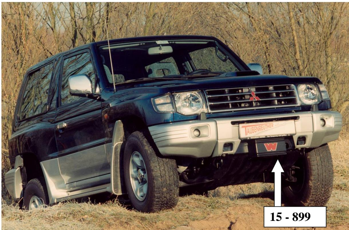
Hier sehen sie den fertig montierten Seilwindenanbausatz.
