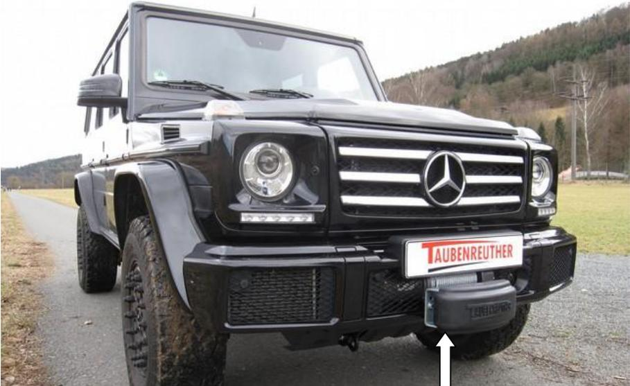
**Das Rollenseilfenster muss auf öffentlichen Straßen mit einer Gummiabdeckung abgedeckt werden.**
