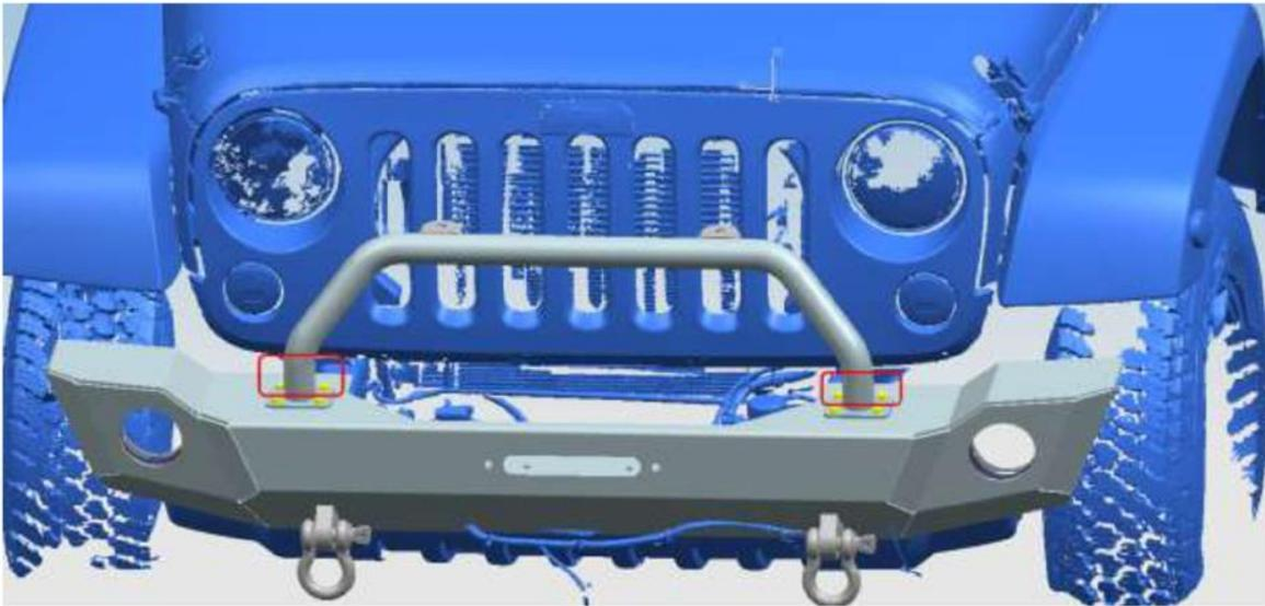
5. Montieren Sie nun die verbliebenen 4 Schrauben um den oberen Bügel zu befestigen
