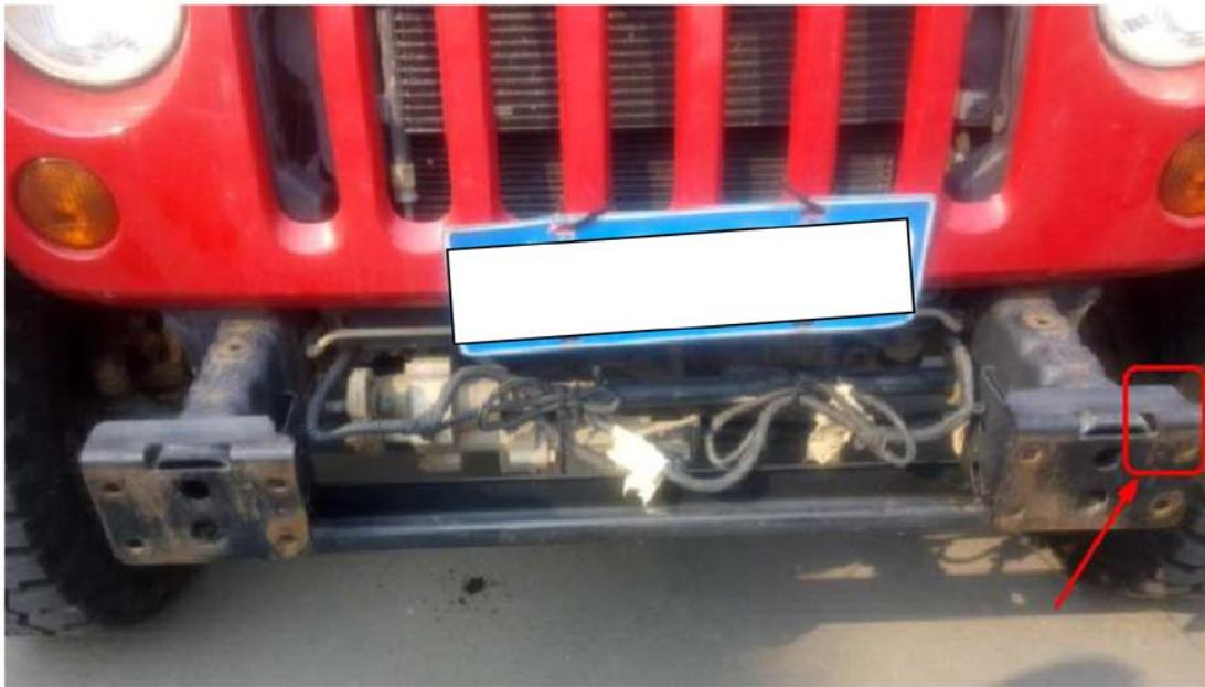
4. Montieren Sie die Stoßstange. Vergrößern Sie das rechte obere Loch (siehe Foto). Stellen Sie sicher, dass die Montageschraube korrekt durch das Loch passt. Richten Sie die Stoßstange am Fahrzeug aus und ziehen Sie dann die Schrauben fest an.
