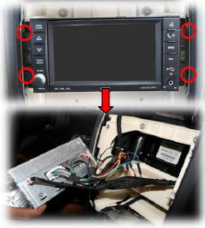
Die graue 22-Pin Buchse auf der Rückseite der Head-Unit herausziehen und mit dem 22-Pin Stecker des Kabelsatzes TV-MYGIG verbinden. Die graue 22-Pin Buchse des Kabelsatzes TV-MYGIG mit der Head-Unit verbinden.
