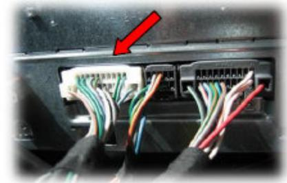
**Hinweis:** Für den Fall, dass der 22-Pin Stecker der Head-Unit **nicht** mit einer weißen 22-Pin Buchse belegt ist, die jeweiligen Pins in die beiliegende 22-Pin Buchse einpinnen.
