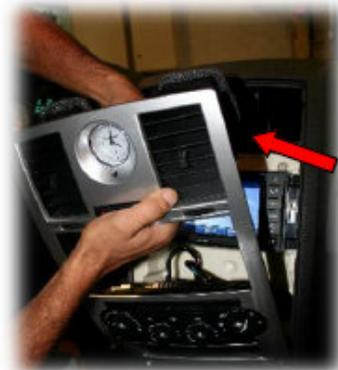
Die 4 TORX Schrauben lösen und die Head-Unit aus der Mittelkonsole herausziehen.
