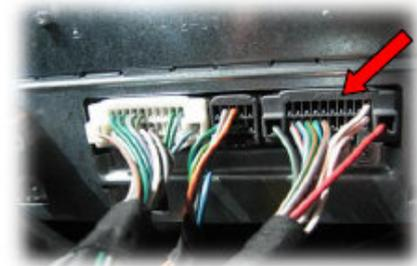
Gemäß der Pinbelegung den AV-Eingang und AV-Ausgang in die weiße 22-Pin Buchse einpinnen und die Cinch Buchsen mit den AV-Quellen und der Rückfahrkamera verbinden.
