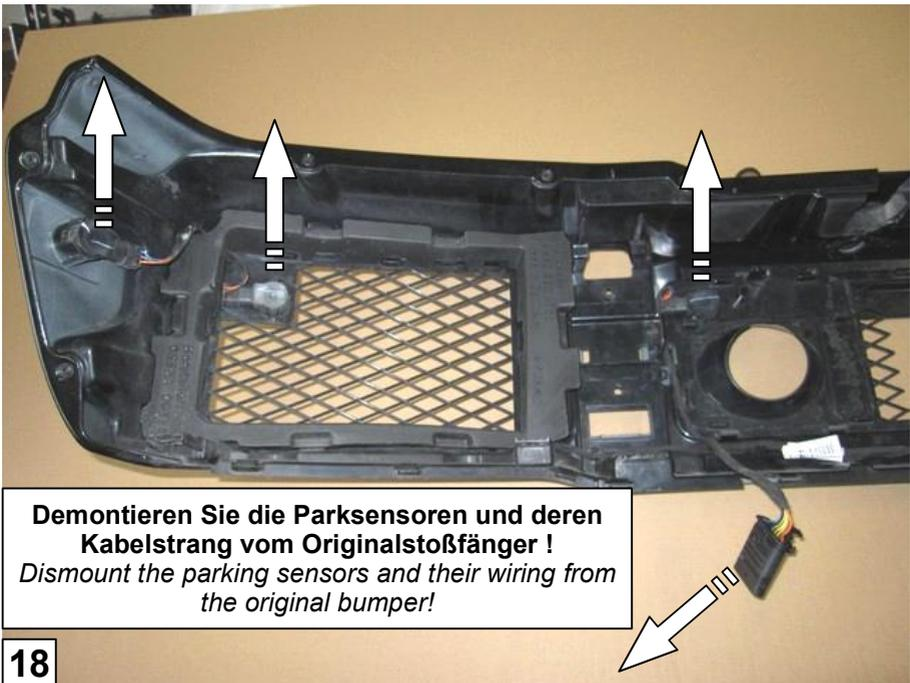
**Demontieren Sie die Parksensoren und deren Kabelstrang vom Originalstoßfänger !**
