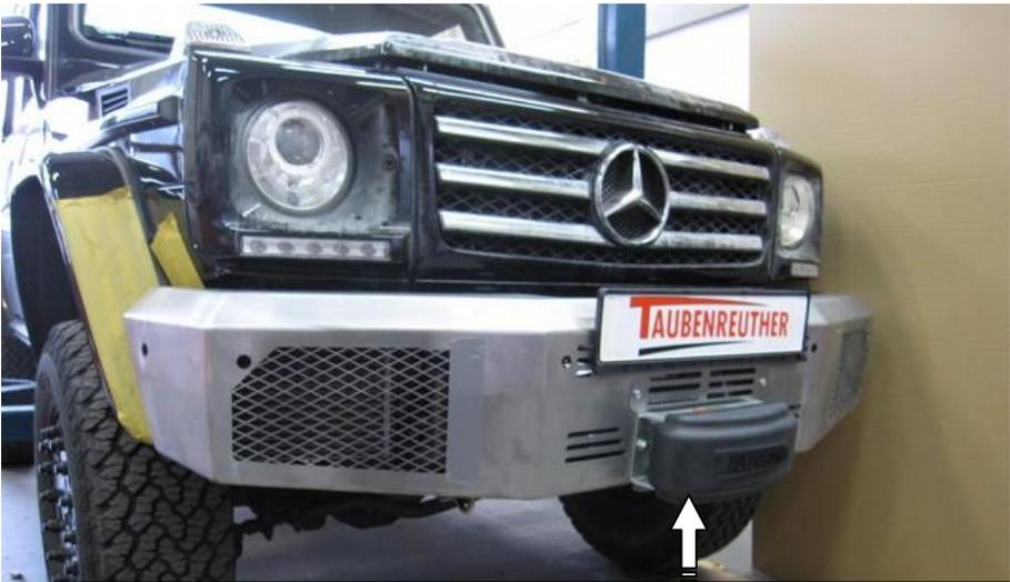
**Das Rollenseilfenster muss bei Fahrten im öffentlichen Straßenverkehr mit einer Gummiabdeckung abgedeckt werden !**
