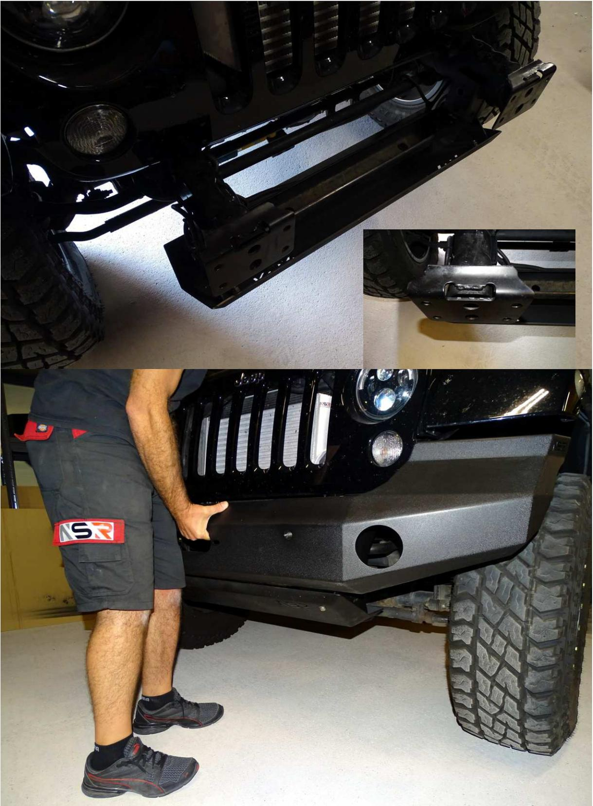
4. Setzen Sie nun alle Schrauben die zur Verschraubung der Stoßstange benötigt werden an. Die zwei längeren Schrauben werden auf der Innenseite an den unteren Löchern angesetzt, diese werden benötigt wenn der NSR Seilwindenträger montiert werden soll.
