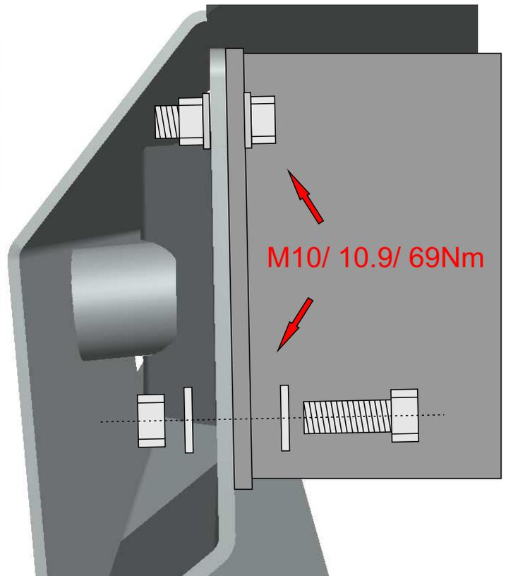
6. Verschrauben Sie nun die Nebelscheinwerfer und die Halterungen in der Stoßstange.
