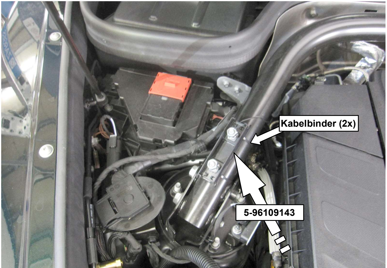
26 Sicherungshalter einbauen! / Mount the fuse holder!
