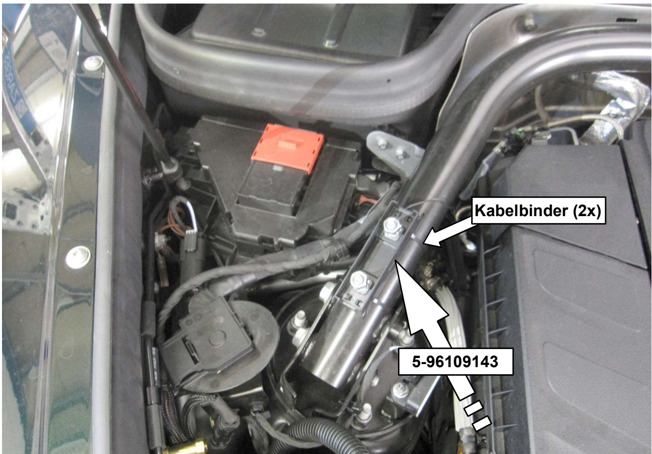
26 Sicherungshalter einbauen! / Mount the fuse holder!
