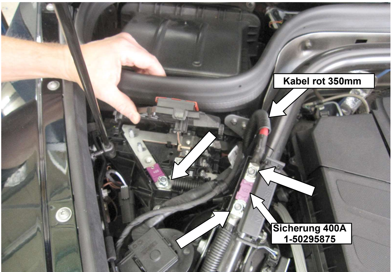
27 Pluskabel anschließen / Connect plus cable!
