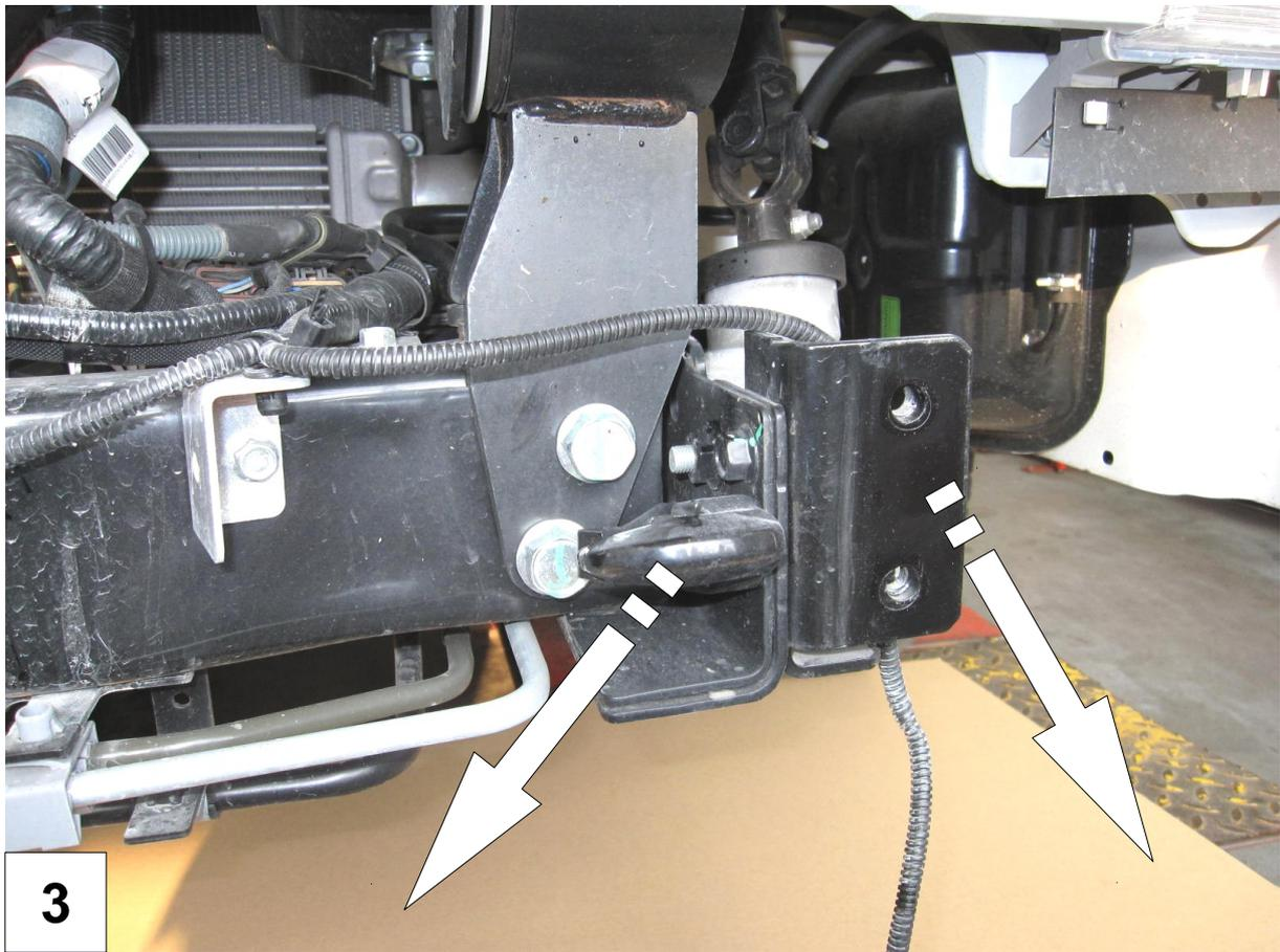
**Sichern sie die Quertraverse zusätzlich mit den Schrauben M 14 x 40 !**
