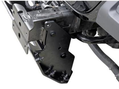
Schritt 5 (Bilder oben & rechts) = Nachdem die beiden Halterungen nun handfest befestigt sind, können Sie die Unterfahrerschutzplatte von vorne an die Halterungen schrauben. Dazu nehmen Sie sich bitte die Platte und jeweils 3 x Senkkopfschrauben M10 x 35, 3 x U-Scheiben 10,5 und 3 x Mutter M10 pro Seite. Ziehen Sie alle Schrauben handfest an und richten Sie den Unterfahrerschutz aus.
