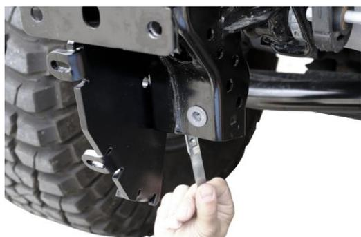
Schritt 4 (Bild links) = In die Öffnung vom Rahmen wird nun die mitgelieferte Gewindeplatte mit Verlängerung eingeführt. Bitte positionieren Sie diese so, dass das Gewinde direkt hinter dem Loch der Halterung liegt. Nun wird von vorne die Gewindeschraube M10 x 30 zusammen mit einer U-Scheibe 10,5 handfest verschraubt. Nun ist die erste Seite montiert und Sie wiederholen die beiden Schritte (3 & 4) auf der anderen Seite.
