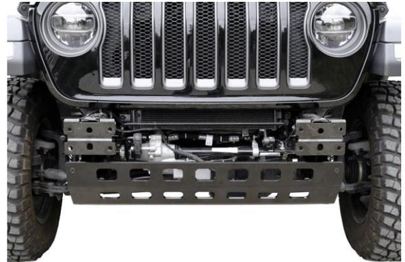
Schritt 6 = Nun können Sie die original Stoßstange bzw. Zubehörstoßstange wieder an dem Rahmen befestigen. Ziehen Sie auch diese Schrauben gut fest. Danach werden die Stecker von den Scheinwerfern wieder aufgesteckt.
