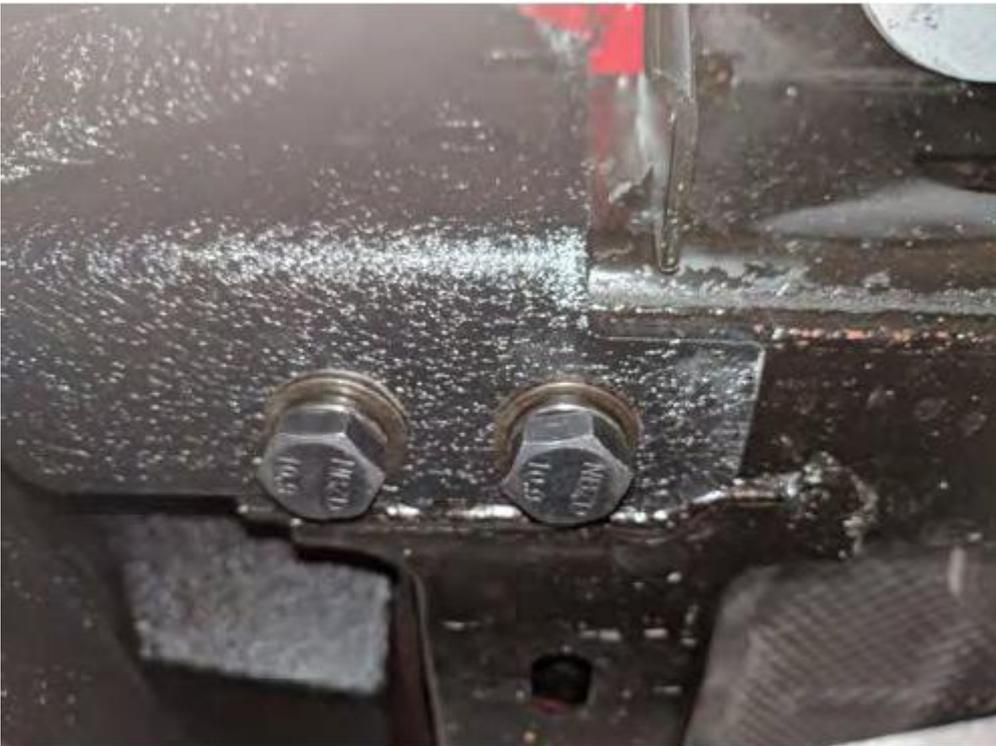
10. Befestigen Sie nun die Abdeckplatten sowie den Kennzeichenhalter mit den acht M10 Schrauben.
