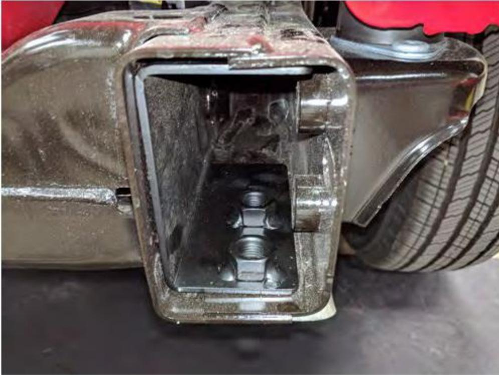
9. Befestigen Sie nun die neue Stoßstange am Fahrzeug. Verwenden Sie hierzu die 4 9/16 Schrauben, U-Scheiben und Sicherungsscheiben. Anzugsmoment: ca. 54Nm.
