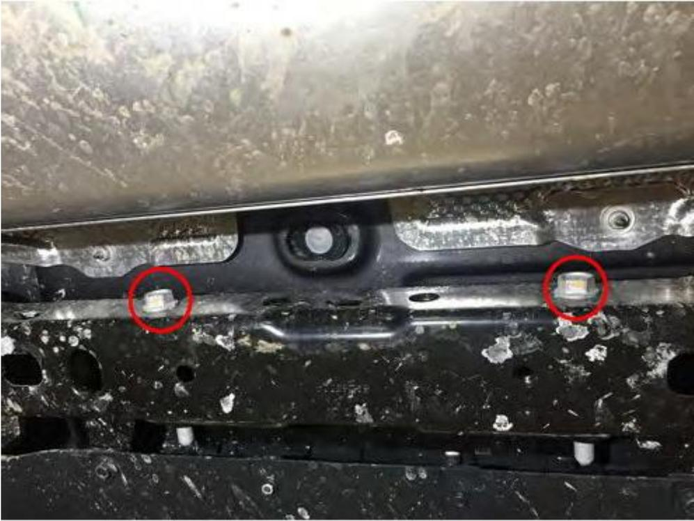
5. Entfernen Sie nun die drei 8mm Schrauben, mit denen der Spritzschutz an der Stoßstange befestigt ist und entfernen Sie diesen.
