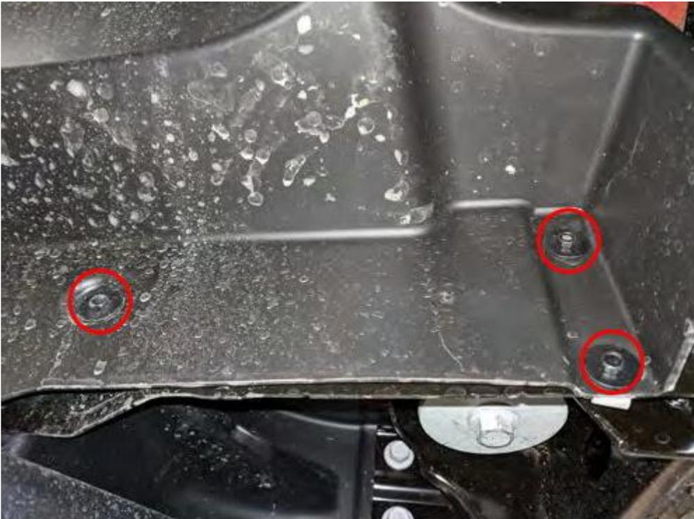
6. Nachdem Sie den Spritzschutz entfernt haben, lösen Sie die beiden 16mm Schrauben mit denen die Halterung für den Spritzschutz an der Stoßstange befestigt ist. Die Stoßstange ist jetzt gelöst.
