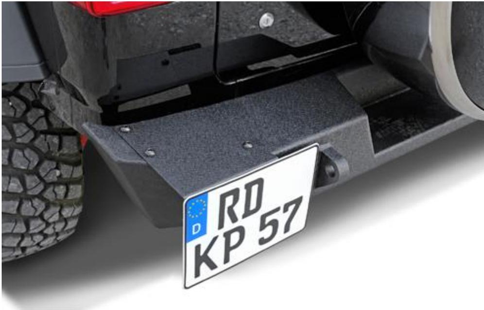
11. Überprüfen Sie regelmäßig den korrekten Sitz der Stoßstange und stellen Sie sicher, dass alle Schrauben fest angezogen sind.
