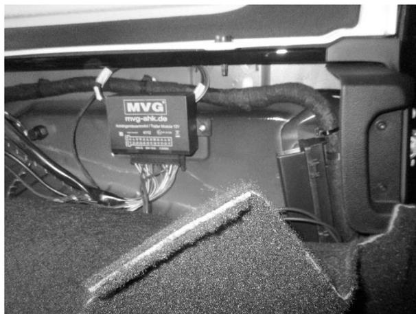
Das Anhängersteuermodul 4112 auf den 24-pol. Sockel aufstecken und mit den beiden Blechschrauben 4,8 x 16 befestigen.
