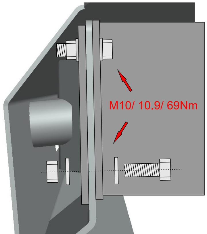
6. Verschrauben Sie nun die Nebelscheinwerfer und die Halterungen in der Stoßstange.
