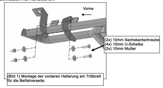
3. Wiederholen Sie den **Schritt 2** um die Halterungen für hinten an der Halterung am Trittbrett zu montieren, **(Bild 2)**.
