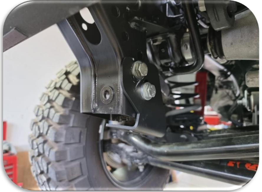
5. Damit sich die Stoßstange und der unterfahr Schutz komplett nach oben schieben lassen ( für maximalen Böschungswinkel) .Müssen 2 Aussparungen für die Kontermutter mit einem Dremel oder einer Säge geschaffen werden
