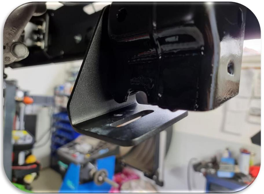
6. Den Unterfahrschutz (am Besten zu Zweit) Ranhalten und mit den Beiliegenden Geschwärtzen Innensechskantschrauben mit Kunststoffscheibe Befestigen. Schrauben nur leicht ansetzen!
