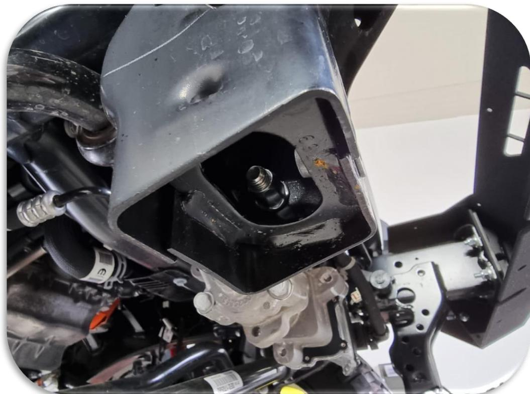
4. Nun die 4 Großen Unterlegscheiben auf die Nietmutter Legen und die 2 oberen Schrauben leicht eindrehen, danach den Montagehalter und die 2 unteren schrauben befestigen sodass der halter sich noch bewegen lässt siehe Bild.
