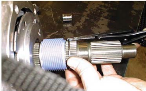
(Fig. 9A) Speed-o-Ring Gear Install
