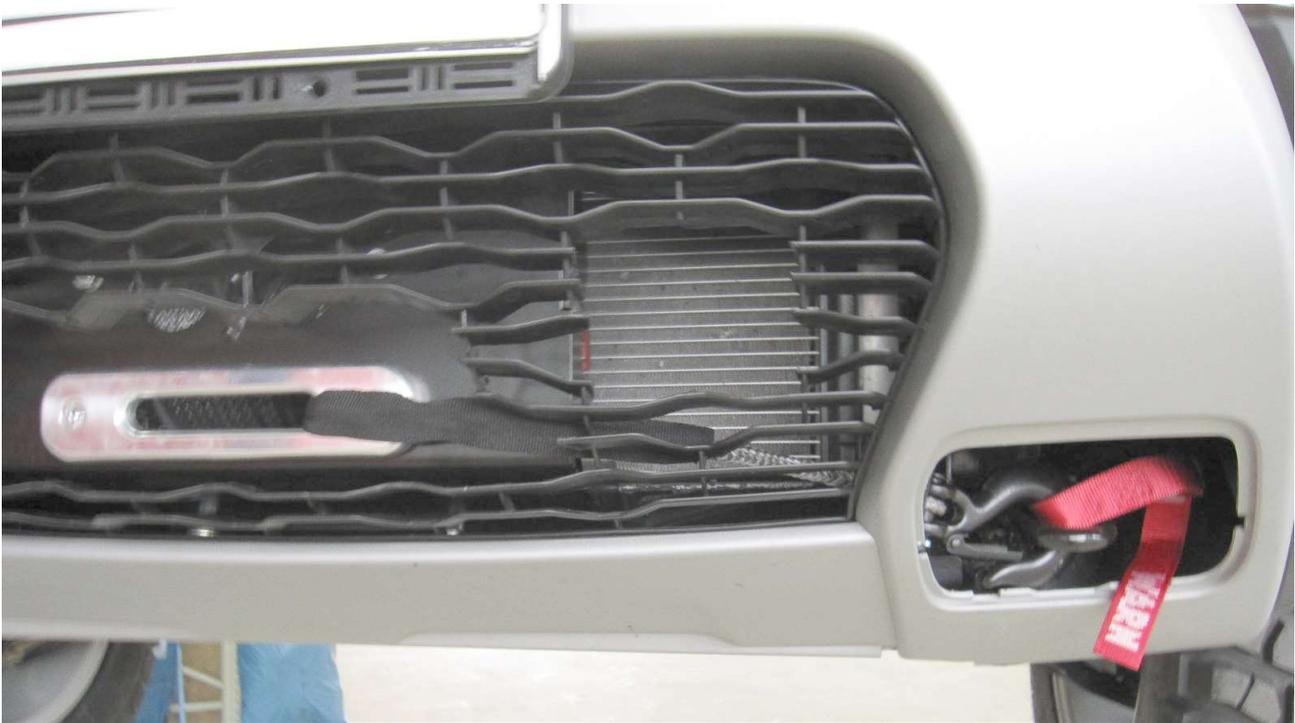
**Bei Fahrten im öffentlichen Straßenverkehr muß das Seil hinter dem Stoßfänger durchgeführt und in der Abschleppöse eingehakt werden.**
