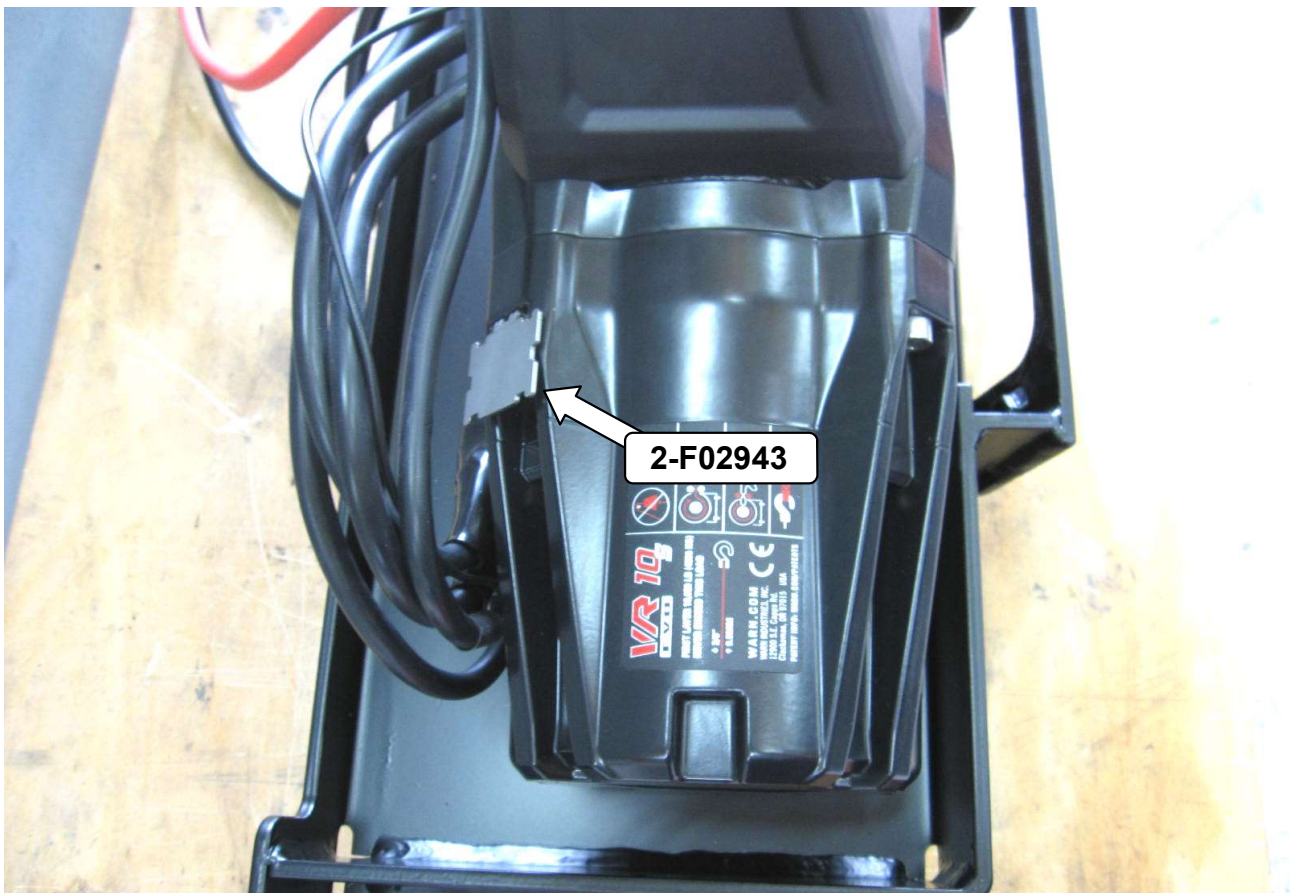
Kabelhalter (2-F02943) mit der Originalschraube befestigen! Fasten the cable holder (2-F02943) with the original screw!
