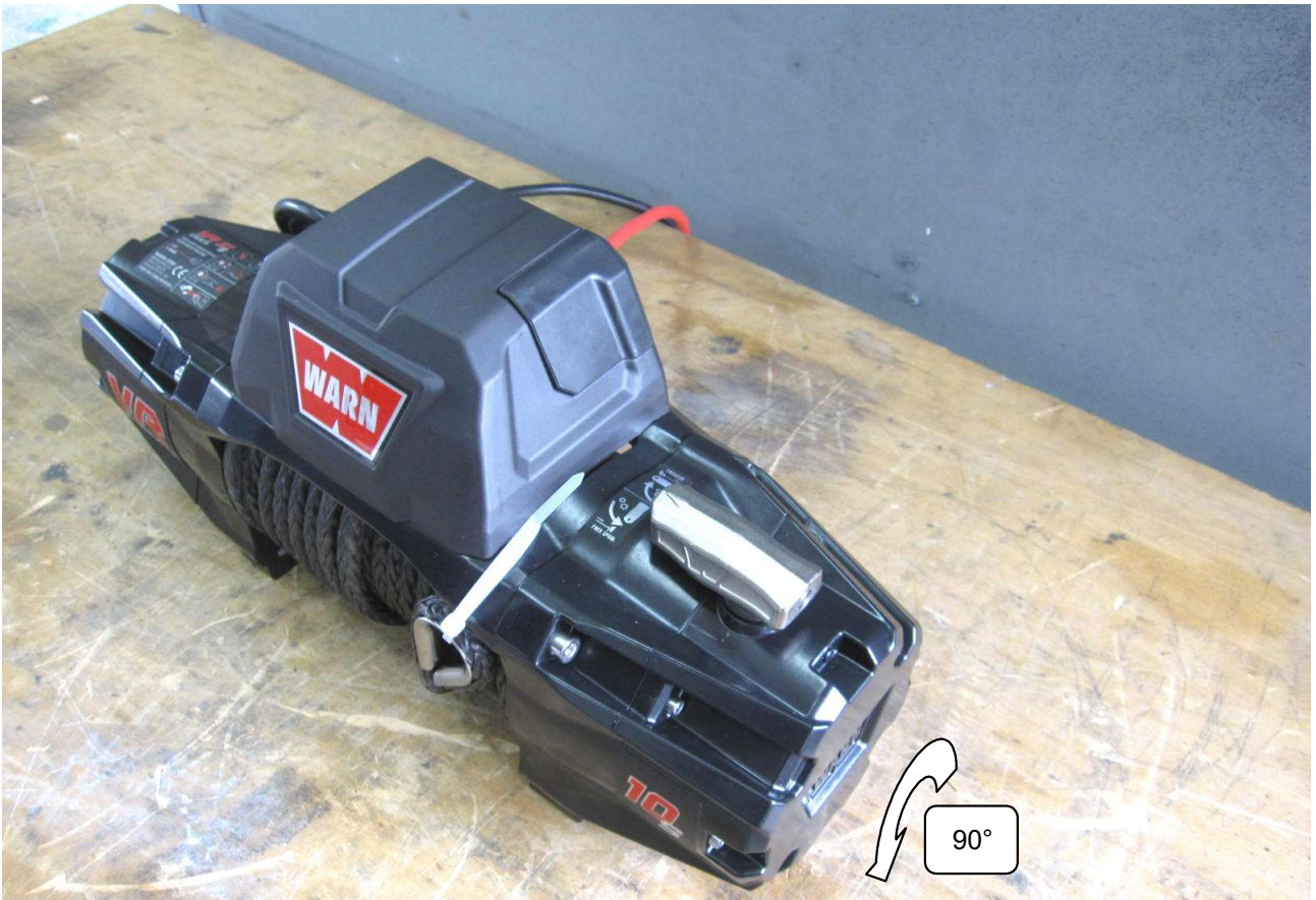
7 Getriebedeckel abnehmen und um 90° nach vorne drehen! Remove gearbox cover and turn it 90° to the front!
