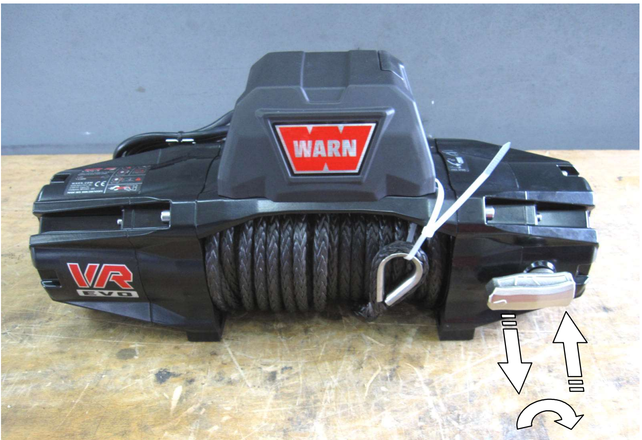
8 Freilaufhebel ausbauen und um 180° verdreht wieder montieren! Remove the free spool lever, turn to 180° and mount it again!
