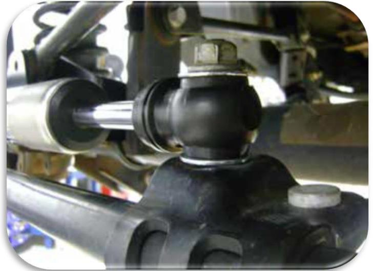
1. Klemmschelle an der Spurstange (SW15) lösen und Verdrehen (Bild1) Lenkungsämpfer dann mit beiliegender Unterlegscheibe montieren und ansetzen (SW18)
