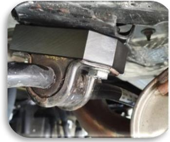
4. Die End Links nun in Stabi und Achse einbauen,
